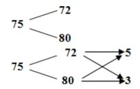
(800:(5+3)=100г приходится на одну часть для получения 800 г сплава нужно взять: 72%-ного сплава  $100\times5=500$ г, а 80%-ого  $100\times3=300$ г
